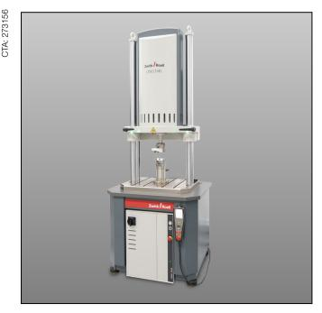
Elektro-dynamische Prüfmaschine LTM 3 Torsion
