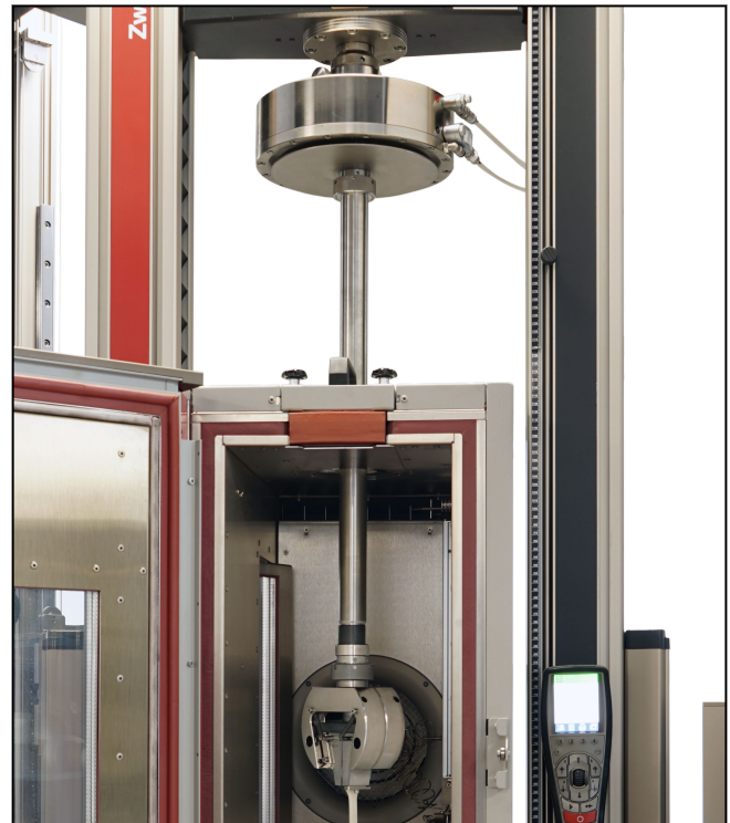
Pneumatik-Probenhalter Typ 8304, Fmax 20 kN mit pneumatischer Betätigung, Temperierkammer
