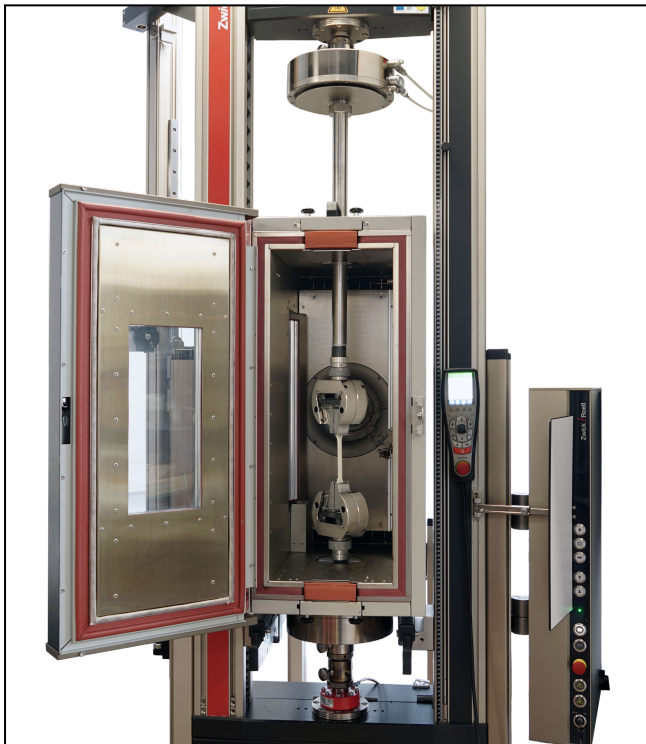
Pneumatik-Probenhalter Typ 8304, Fmax 20 kN mit pneumatischer Betätigung, Temperierkammer
