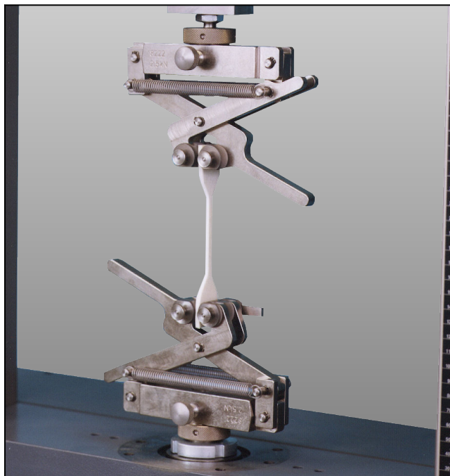
Zangen-Probenhalter Typ 8222, Fmax 2,5 kN
